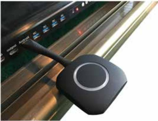
Es un dispositivo que realiza la sincronización entre la BigTablet y un equipo portátil con conexión USB. Replicando la pantalla del equipo, volviéndola interactiva a través de la BigTablet. Simplifica la utilización de otros dispositivos como el data show (acumulación de basura tecnológica)
